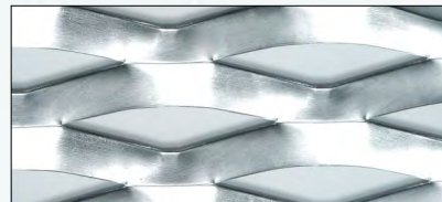
Verkon silmätyyppi, kokonaisavoimuus min. 30%, verkon avoimuus min. 50%
